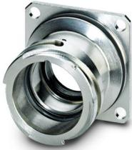
Carcasa para conector circular, serie: TU, recto, Bloqueo de bayoneta, M23, número de polos: 12, tipo de conexión del contacto: Hembra, Conexión crimpada, Anillo tórico radial, apantallado: sí, espesor de pared mín.: 3,5 mm
