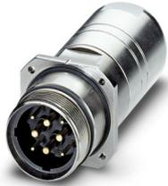
Pasamuro pared posterior, recto, Bloqueo por tornillo, M40, número de polos: 2+3+PE, tipo de conexión del contacto: Macho, Anillo tórico axial, 4xM4, apantallado: sí, rango de diámetro de cable: 9 mm ... 12,5 mm, número de polos: 6, tipo de conexión: Conexión crimpada, serie: SM
