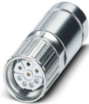
Conector para cables, recto largo, Bloqueo por tornillo, M23, número de polos: 5+PE, tipo de conexión del contacto: Hembra, apantallado: sí, índice de protección: IP67, rango de diámetro de cable: 7,5 mm ... 18 mm, número de polos: 6, tipo de conexión: Conexión crimpada, serie: SF, se espera que este artículo no contenga plomo a partir del primer trimestre de 2026 de acuerdo con RoHS II sin excepción 6c (Pb <0,1 %), una alternativa sin plomo está disponible previamente a petición
