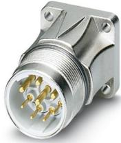
Conect. enchuf. para apar. pared delant., recto, para bloqueo estándar y SPEEDCON, M23, número de polos: 5+PE, tipo de conexión del contacto: Macho, Anillo tórico axial, apantallado: sí, medida de brida: 26 mm x 26 mm, Compatible con contraconectores con tuerca moleteada SPEEDCON o M23 estándar, número de polos: 6, tipo de conexión: Conexión crimpada, serie: SF
