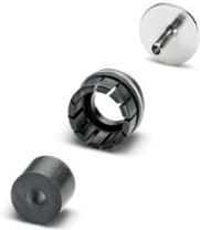
Empaquetadura de fijación del cable y adaptador de pantalla, apantallado: sí, diámetro del haz de hilos trenzados: 3,2 mm, rango de diámetro de cable: 4,5 mm ... 5,5 mm, serie: NC, RC, se espera que este artículo no contenga plomo a partir del primer trimestre de 2027 de acuerdo con RoHS II sin excepción 6c (Pb <0,1 %), una alternativa sin plomo está disponible previamente a petición
