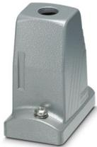
HEAVYCON ADVANCE con recubrimiento de polvo estándar, carcasa aérea B6, con bloqueo por tornillo, altura 100 mm, con rosca 1x M20, salida de cables recta
