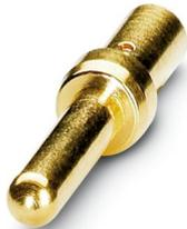
Contacto crimpado, Macho, mecanizado, diámetro de contacto: 1 mm, sección de conexión: 0,08 mm<sup>2</sup> ... 0,22 mm<sup>2</sup>, material contacto: CuZn , Producto alternativo según RoHS II sin excepción 6c (Pb < 0,1 %) código de art.: 1240882
