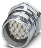
M23, Conect. enchuf. para apar. pared delant., serie: RC, recto, apantallado: sí, Bloqueo por tornillo, N° de polos: 6, Sentido de giro: Estándar, tipo de conexión del contacto: Macho, Copa de soldar, Anillo tórico axial, Espesor de pared mín.: 0,8 mm, Espesor de pared máx.: 6,5 mm, codificación: N
