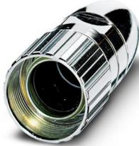
Carcasa para conector circular, serie: RC, recto, Bloqueo por tornillo, M23, número de polos: 12, apantallado: no, rango de diámetro de cable: 2 mm... 10,5 mm, se espera que este artículo no contenga plomo a partir del primer trimestre de 2027 de acuerdo con RoHS II sin excepción 6c (Pb <0,1 %), una alternativa sin plomo está disponible previamente a petición
