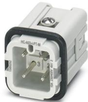
Inserto de contactos, número de polos: 3+PE, tamaño: D7, número de conexiones por polo: 1, Macho, Conexión push-in, 230 V/400 V, 10 A, 0,14 mm<sup>2</sup> ... 1,5 mm<sup>2</sup>
