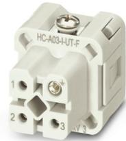
Inserto de contactos, número de polos: 3+PE, tamaño: D7, número de conexiones por polo: 1, Hembra, Conexión por tornillo, 230 V/400 V, 10 A, 0,5 mm<sup>2</sup> ... 2,5 mm<sup>2</sup>
