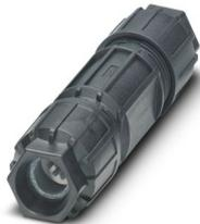
Econnecteur de câble, tipo de conexión: Conexión IDC, número de polos: 3+PE, 1 mm<sup>2</sup> ... 2,5 mm<sup>2</sup>, 690 V, 20 A, PA, negro, con dos tuercas QUICKON, codificación: Perfil codificador, diámetro exterior del cable: 9 mm ... 14 mm
