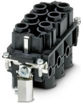
Inserto de contactos, número de polos: 6+PE, tamaño: B16, contactos de potencia: 6, contactos de mando: 0, Hembra, Conexión por tornillo, 1000 V, 80 A, 6 mm<sup>2</sup> ... 16 mm<sup>2</sup>, aplicación: Potencia
