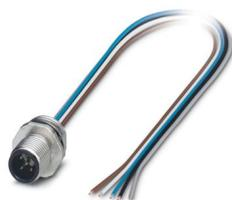
Macho de montaje incorporado para sensores/actuadores, 5 polos, M12, codificado A, montaje en paredes delanteras/montaje atornillado con rosca Pg9, con hilo trenzado TPE de 0,115 m, 5 x 0,34 mm<sup>2</sup>
