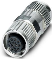
Conector, Universal, 12-polos, Hembra de conexión recto M12 SPEEDCON, codificación: A, Conexión rápida Piercecon®, material de moleteado: Fundición inyectada de cinc, niquelada, diámetro exterior del cable 5,4 mm ... 8,2 mm
