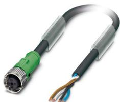
Cable para sensores/actuadores, 4-polos, PUR, negro grisáceo RAL 7021, extremo de cable libre, a Hembra recta M12 SPEEDCON, codificación: A, longitud de cable: 10 m
