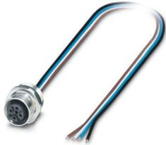
Conect. enchuf. para apar. pared delant., Universal, 4-polos, Hembra de conexión, recto, M12-Estándar, A-codificación, a extremo de cable libre, Hilos trenzados individuales, longitud de cable: 0,5 m, 0,34 mm<sup>2</sup>, Hilo trenzado TPE, encapsulado
