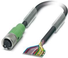
Cable para sensores/actuadores, 17-polos, PVC, negro RAL 9005, extremo de cable libre, a Hembra recta M12 SPEEDCON, codificación: A, longitud de cable: 5 m
