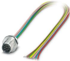
Conect. enchuf. para apar. pared delant., Universal, 8-polos, Conector macho, recto, M12-Estándar, A-codificación, a extremo de cable libre, Hilos trenzados individuales, longitud de cable: 0,5 m, 0,25 mm<sup>2</sup>, Hilo trenzado TPE, encapsulado, se espera que este artículo no contenga plomo a partir del cuarto trimestre de 2025 de acuerdo con RoHS II sin excepción 6c (Pb <0,1 %), una alternativa sin plomo está disponible previamente a petición
