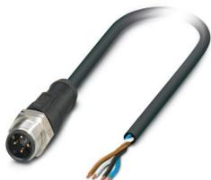
Cable para sensores/actuadores, 4-polos, Mezcla especial sobre la base de PVC, negro RAL 9005. Conector recta M12, codificación: A, a extremo de cable libre, longitud de cable: 3 m, para la industria alimentaria, con moleteado de acero inoxidable
