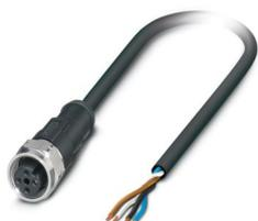
Cable para sensores/actuadores, 4-polos, Mezcla especial sobre la base de PVC, negro RAL 9005, extremo de cable libre, a Hembra recta M12, codificación: A, longitud de cable: 10 m, para la industria alimentaria, con moleteado de acero inoxidable
