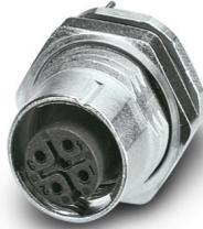
Conect. enchuf. para apar. pared poster., 5-polos, Hembra de conexión, recto, M12-SPEEDCON, A-codificación, Soldadura por ola, se espera que este artículo no contenga plomo a partir del segundo trimestre de 2026 de acuerdo con RoHS II sin excepción 6c (Pb <0,1 %), una alternativa sin plomo está disponible previamente a petición
