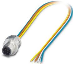
Conect. enchuf. para apar. pared delant., PROFINET CAT5 (IEC 11801:2002), 4-polos, Conector macho, recto, M12-SPEEDCON, D-codificación, a extremo de cable libre, Hilos trenzados individuales, longitud de cable: 0,5 m, 0,34 mm<sup>2</sup>, Hilo trenzado TPE, encapsulado, se espera que este artículo no contenga plomo a partir del tercer trimestre de 2025 de acuerdo con RoHS II sin excepción 6c (Pb <0,1 %), una alternativa sin plomo está disponible previamente a petición
