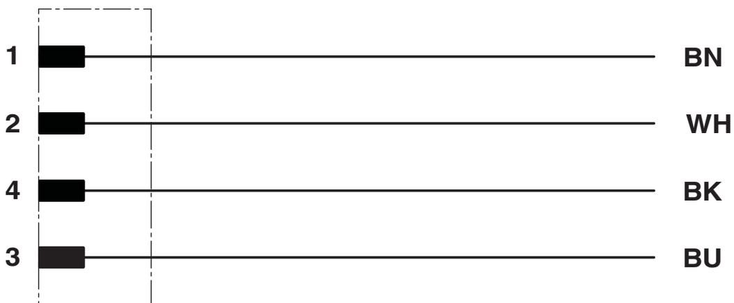
Ocupación de contactos del conector macho M12 y del conector hembra M12
