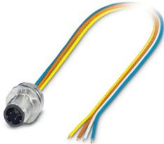
Conect. enchuf. para apar. pared delant., PROFINET CAT5 (IEC 11801:2002), 4-polos, Conector macho, recto, M12-SPEEDCON, D-codificación, a extremo de cable libre, Hilos trenzados individuales, longitud de cable: 0,5 m, 0,34 mm<sup>2</sup>, Hilo trenzado TPE, encapsulado
