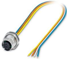
Conect. enchuf. para apar. pared poster., PROFINET CAT5 (IEC 11801:2002), 4-polos, Hembra de conexión, recto, M12-SPEEDCON, D-codificación, a extremo de cable libre, Hilos trenzados individuales, longitud de cable: 0,5 m, 0,34 mm<sup>2</sup>, Hilo trenzado TPE, encapsulado, se espera que este artículo no contenga plomo a partir del segundo trimestre de 2026 de acuerdo con RoHS II sin excepción 6c (Pb <0,1 %), una alternativa sin plomo está disponible previamente a petición
