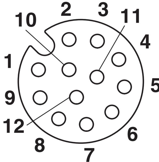
Esquema de polos del conector hembra M12, 12 polos, vista de la cara de hembras
