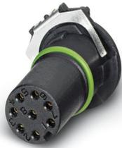
Soporte de contactos, 8-polos, Hembra de conexión, recto, M12, A-codificación, Conexión por soldadura THR, se espera que este artículo no contenga plomo a partir del cuarto trimestre de 2025 de acuerdo con RoHS II sin excepción 6c (Pb <0,1 %), una alternativa sin plomo está disponible previamente a petición
