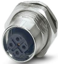
Conect. enchuf. para apar. pared poster., 5-polos, Hembra de conexión, recto, M12-SPEEDCON, B-codificación, Soldadura por ola, se espera que este artículo no contenga plomo a partir del segundo trimestre de 2026 de acuerdo con RoHS II sin excepción 6c (Pb <0,1 %), una alternativa sin plomo está disponible previamente a petición
