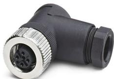
Conector, Universal, 5-polos, Hembra de conexión acodado M12 SPEEDCON, codificación: A, Conexión por tornillo, material de moleteado: Latón, niquelado, prensaestopas Pg9, diámetro exterior del cable 6 mm ... 8 mm
