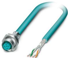
Conect. enchuf. para apar. pared poster., Ethernet CAT5 (100 MBit/s), Ethernet, 4-polos, PUR, azul agua RAL 5021, apantallado, Hembra de conexión, recto, M12, D-codificación, a extremo de cable libre, Conexión de cable, longitud de cable: 0,5 m, Ethernet flexible CAT5, 2 pares, se espera que este artículo no contenga plomo a partir del primer trimestre de 2027 de acuerdo con RoHS II sin excepción 6c (Pb <0,1 %), una alternativa sin plomo está disponible previamente a petición
