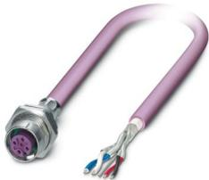
Conect. enchuf. para apar. pared poster., CANopen®, DeviceNet™, 5-polos, PUR sin halógenos, rojo lila RAL 4001, apantallado, Hembra de conexión, recto, M12-SPEEDCON, A-codificación, a extremo de cable libre, Conexión de cable, longitud de cable: 2 m, CANopen®/DeviceNet™, PUR, violeta, se espera que este artículo no contenga plomo a partir del primer trimestre de 2027 de acuerdo con RoHS II sin excepción 6c (Pb <0,1 %), una alternativa sin plomo está disponible previamente a petición
