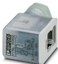
Conector de válvula, 3-polos, Conector de válvula B (10 mm), Conexión por tornillo, prensaestopas Pg9, diámetro exterior del cable 6 mm ... 8 mm
