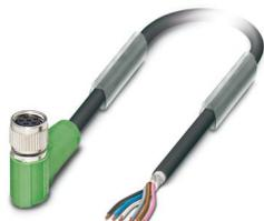
Cable para sensores/actuadores, 6-polos, PUR sin halógenos, negro grisáceo RAL 7021, apantallado, extremo de cable libre, a Hembra acodado M8, codificación: A, longitud de cable: 3 m
