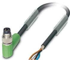
Cable para sensores/actuadores, 4-polos, PUR sin halógenos, negro grisáceo RAL 7021, apantallado, Conector acodado M8, codificación: A, a extremo de cable libre, longitud de cable: 10 m
