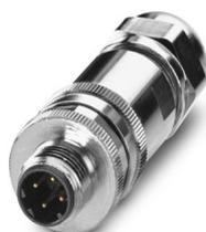
Conector para datos, Ethernet CAT5 (100 MBit/s), 4-polos, apantallado, Conector macho recto M12, codificación: D, Conexión por tornillo, material de moleteado: Latón, niquelado, prensaestopas Pg7, diámetro exterior del cable 4 mm ... 6 mm
