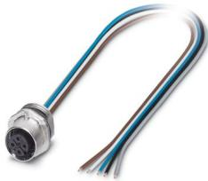
Conect. enchuf. para apar. pared delant., Universal, 5-polos, Hembra de conexión, recto, M12-SPEEDCON, A-codificación, a extremo de cable libre, Hilos trenzados individuales, longitud de cable: 0,5 m, 0,34 mm<sup>2</sup>, Hilo trenzado TPE, encapsulado
