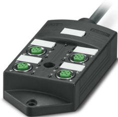
Caja distribuidora, aplicación: Estándar, requisitos ampliados, tipo de conexión: Conector hembra M12 Metal, número de puestos enchufables: 4, número de polos: 4, codificación: A, ocupación de los puestos enchufables: simple, indicación de estado: sí, PNP; conexión de cable principal: Conexión fija 180°, PUR/PVC, longitud del cable: 10 m, apantallamiento: no
