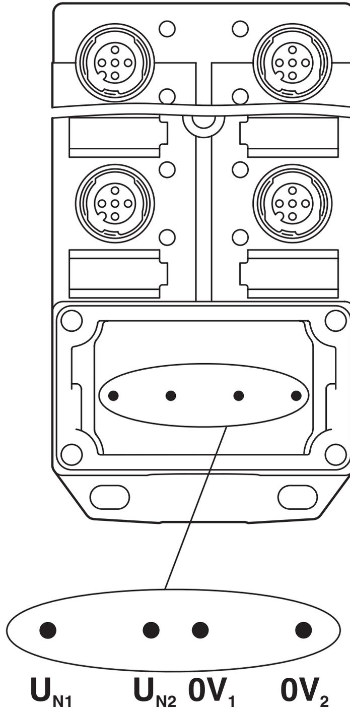
Con separación galvánica. Asignación de potencial:  $U_{N1}$  = receptáculos de conexión 1,3,5,7 y  $U_{N2}$  = receptáculos de conexión 2,4,6,8.
