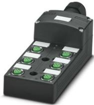
Caja distribuidora, aplicación: Estándar, requisitos ampliados, tipo de conexión: Conector hembra M12 Metal, número de puestos enchufables: 6, número de polos: 5, codificación: A, ocupación de los puestos enchufables: Doble, indicación de estado: no, Universal; conexión de cable principal: Conexión por tornillo enchufable 180°, apantallamiento: no
