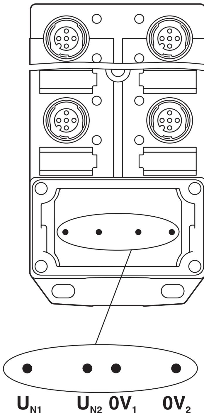
Con separación galvánica. Asignación de potencial:  $U_{N1}$  = receptáculos de conexión 1,3 y  $U_{N2}$  = receptáculos de conexión 2,4.
