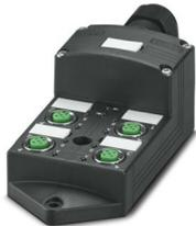
Caja distribuidora, aplicación: Estándar, requisitos ampliados, tipo de conexión: Conector hembra M12 Metal, número de puestos enchufables: 4, número de polos: 4, codificación: A, ocupación de los puestos enchufables: simple, indicación de estado: sí, PNP; conexión de cable principal: Conexión por tornillo enchufable 180°, apantallamiento: no
