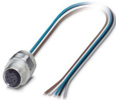
Conect. enchuf. para apar. pared delant., Universal, 5-polos, Hembra de conexión, recto, M12-Estándar, B-codificación, a extremo de cable libre, Hilos trenzados individuales, longitud de cable: 0,5 m, 0,34 mm<sup>2</sup>, Hilo trenzado TPE, encapsulado, se espera que este artículo no contenga plomo a partir del cuarto trimestre de 2025 de acuerdo con RoHS II sin excepción 6c (Pb <0,1 %), una alternativa sin plomo está disponible previamente a petición
