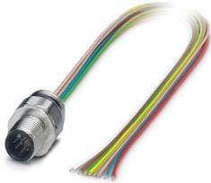
Conect. enchuf. para apar. pared delant., Universal, 8-polos, Conector macho, recto, M12-Estándar, A-codificación, a extremo de cable libre, Hilos trenzados individuales, longitud de cable: 0,5 m, 0,25 mm<sup>2</sup>, Hilo trenzado TPE, encapsulado, se espera que este artículo no contenga plomo a partir del primer trimestre de 2026 de acuerdo con RoHS II sin excepción 6c (Pb <0,1 %), una alternativa sin plomo está disponible previamente a petición
