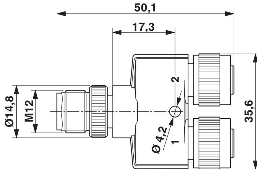
Conector M12 x 1, repartidor Y, medida exacta de 21 mm
