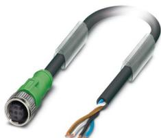
Cable para sensores/actuadores, 4-polos, PUR, negro grisáceo RAL 7021, extremo de cable libre, a Hembra recta M12, codificación: A, longitud de cable: 6 m
