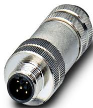
Conector para datos, PROFIBUS, INTERBUS, 5-polos, apantallado, Conector macho recto M12, codificación: B, Conexión por tornillo, material de moleteado: Fundición inyectada de cinc, niquelada, prensaestopas Pg9, diámetro exterior del cable 6,5 mm ... 8,5 mm
