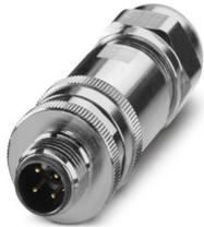
Conector, Universal, 4-polos, apantallado, Conector macho recto M12, codificación: A, Conexión por tornillo, material de moleteado: Latón, niquelado, prensaestopas Pg9, diámetro exterior del cable 6 mm ... 8 mm
