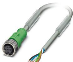
Cable para sensores/actuadores, 5-polos, PUR sin halógenos, resistente a chispas de soldadura, muy flexible, gris RAL 7001, extremo de cable libre, a Hembra recta M12, codificación: A, longitud de cable: 5 m, para robótica y cadenas de arrastre
