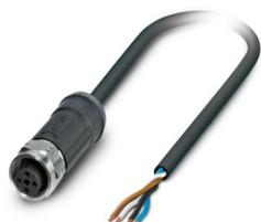
Cable para sensores/actuadores, 4-polos, PE-X sin halógenos, negro grisáceo RAL 7021, extremo de cable libre, a Hembra recta M12, codificación: A, longitud de cable: 5 m, para aplicaciones exteriores, con moletado de acero inoxidable
