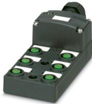
Caja distribuidora, aplicación: Estándar, tipo de conexión: Conector hembra M12 Plástico, número de puestos enchufables: 6, número de polos: 5, codificación: A, ocupación de los puestos enchufables: Doble, indicación de estado: sí, PNP; conexión de cable principal: Conexión por resorte 180°, apantallamiento: no
