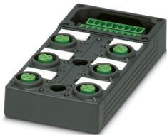
Caja distribuidora de carcasa de base, aplicación: Estándar, tipo de conexión: Conector hembra M12 Plástico, número de puestos enchufables: 6, número de polos: 5, codificación: A, ocupación de los puestos enchufables: Doble, indicación de estado: sí, PNP; conexión de cable principal: Conexión por tornillo enchufable, apantallamiento: no
